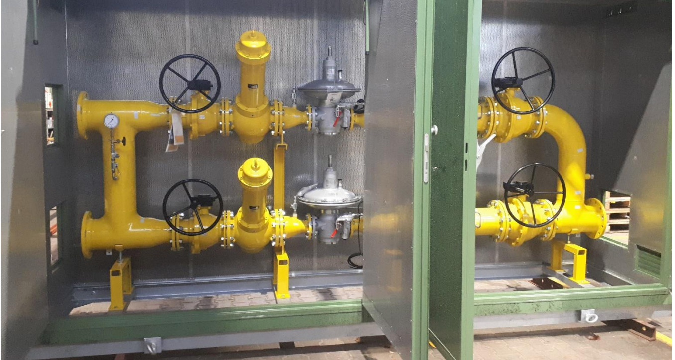
Bereit für den Transport zum Kunden: Die von SPIE konstruierte Wasserstoffeinspeiseanlage in einem Aluminiumschrank. Copyright: SPIE
